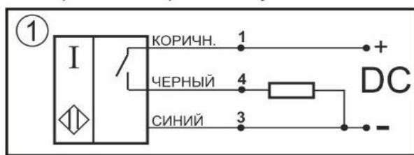
Схема соединения Нормально-разомкнутый контакт
